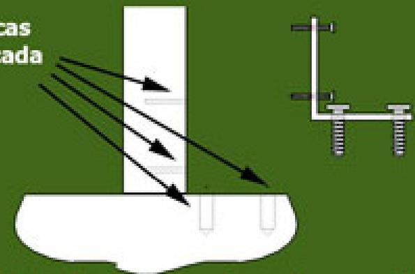
2. Introducir los tacos en el suelo y unir con tirafondos la escuadra al PILAR y con tornillos de anclaje al suelo.
