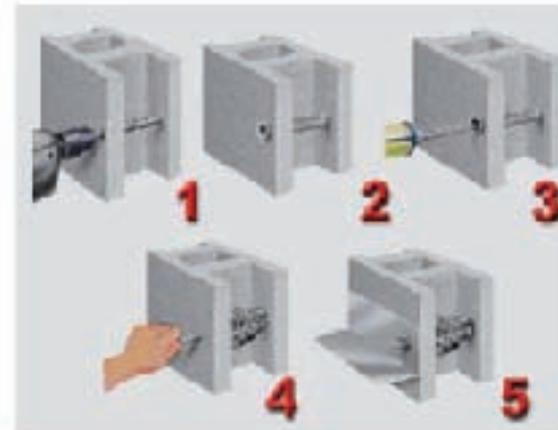
Para hacer anclajes en materiales huecos (ladrillo o bloques de hormigón) se deben usar tamices.
