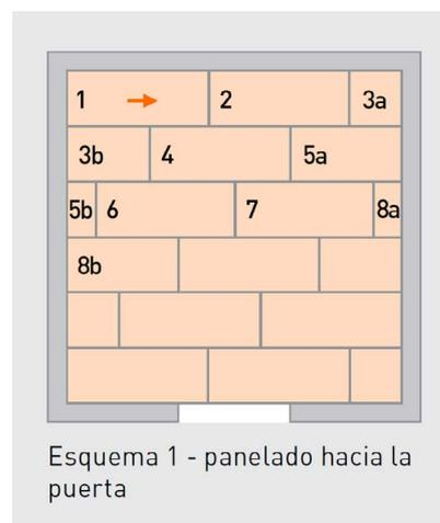
Esquema 1 - panelado hacia la puerta
