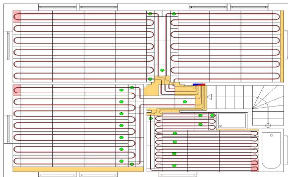
Para la realización de los canales de tubería necesarios, los canales se fresan en las placas base con una fresadora. Antes de fresar, es útil premarcar el camino de todos los canales necesarios en las placas.
